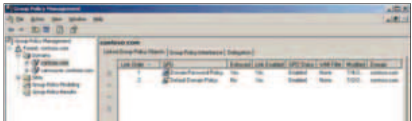
С помощью этого окошка можно разграничивать права для каждой группы пользователя сети
